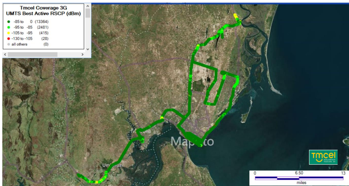
Figura 5. Representação da cobertura 3G da Tmcel, S.A
